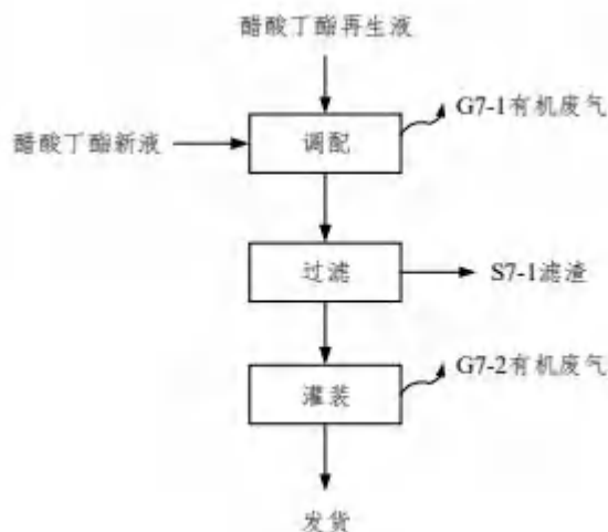
图 4.1-12 醋酸丁酯工艺流程及产污环节图
