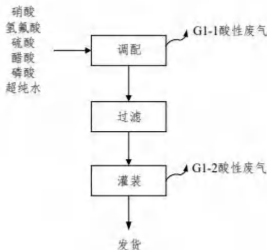
图 4.1-7 硝化酸混合物工艺流程及产污环节图
